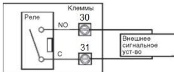
Релейный выход конфигурируется пользователем и может быть сконфигурирован на подачу аварийного сигнала типа ВКЛ/ВЫКЛ или сигнала импульса суммирующего счетчика. Его сигнал отправляется на зажимы 30 и 31, которые могут быть подключены к удаленному счетчику или устройству аварийной сигнализации. См. о конфигурации реле через окно M79 в следующей главе.
