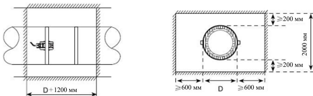
**D** означает наружный диаметр трубы.
