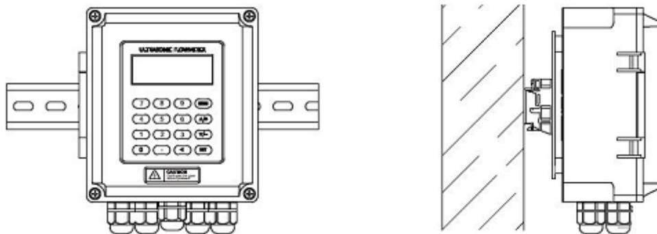
★ Преобразователь SLS-720F может быть установлен на стене или в распределительной коробке и взрывозащитном ящике.
